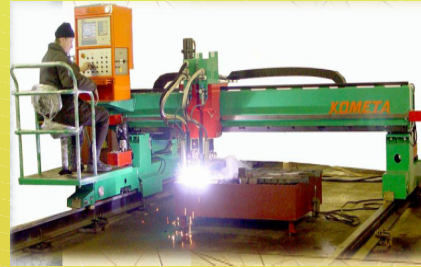
Заготовительное производство Раскрой листового проката на машинах термической резки, гибка деталей на вальцах и прессах
